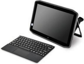
Fin et léger, le clavier Bluetooth se range au dos de la tablette dans le support inclus. Lorsque le support est fermé, le clavier se recharge en cours de transport, pour être toujours prêt. Son port micro USB prend également en charge l'alimentation secteur.
